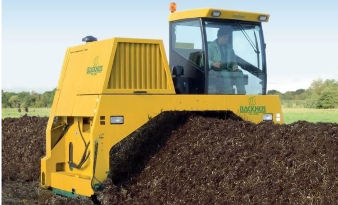
Εικόνα 32: Αναστροφέας σειραδίων τριγωνικής διατομής
