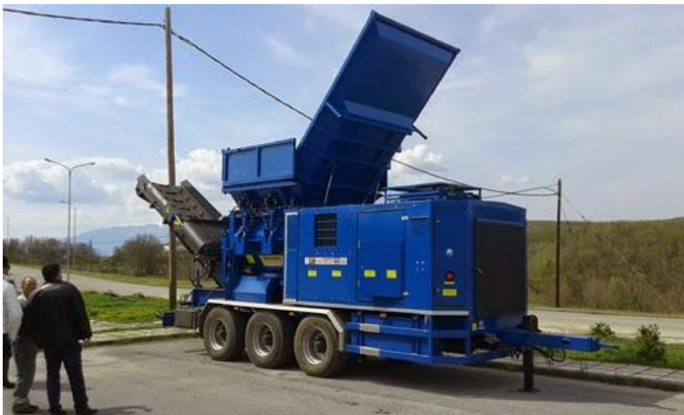
Εικόνα 28: Τεμαχισμός απορριμμάτων με απομάκρυνση μεταλλικών αντικειμένων
