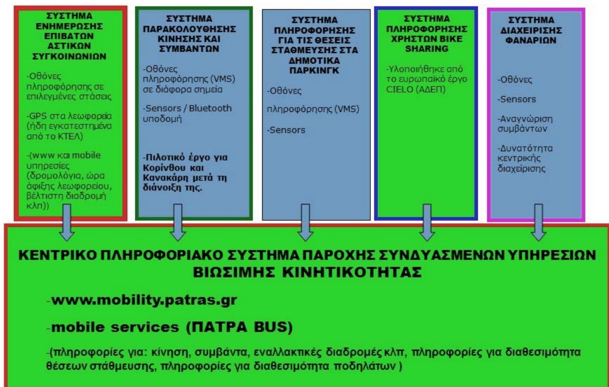
Εικόνα 143: Σχηματικό διάγραμμα συστήματος (Με πράσινο φαίνονται οι ήδη υλοποιημένες εφαρμογές)
