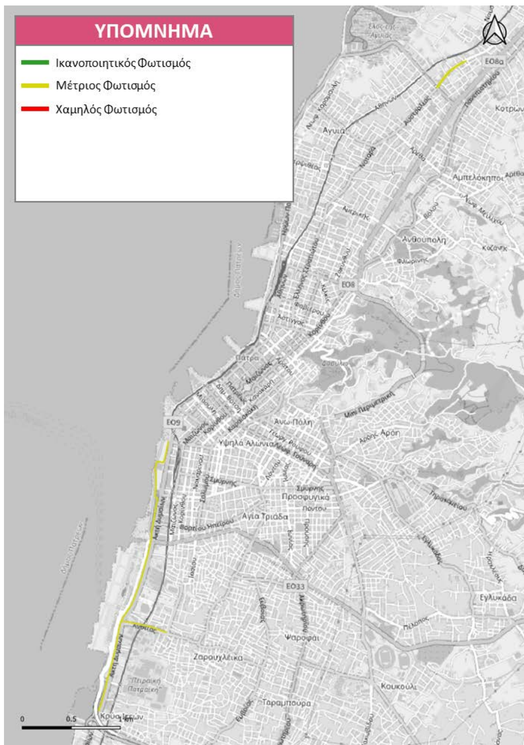
Εικόνα 58: Αξιολόγηση δικτύου ποδηλατοδρόμων στην περιοχή μελέτης: Επάρκεια φωτισμού
