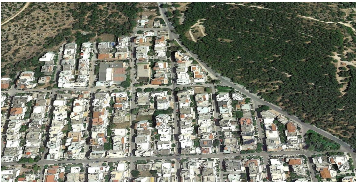
Εικόνα 7.1. Η δομημένη περιοχή που συνορεύει περιμετρικά με δάσος ή δασική έκταση και δεν υπάρχει συνέχεια σε καύσιμα δασικής προέλευσης μεταξύ των κτιρίων που την συγκροτούν.
