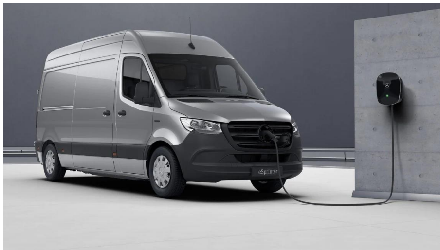
Εικόνα 4.3 Το Mercedes-Benz eSprinter Van το οποίο πωλείται δύο διαφορετικές εκδόσεις με μπαταρία χωρητικότητας από 35 και 47 kWh, χρόνο φόρτισης με AC 6 ώρες και 8 ώρες αντίστοιχα και αυτονομία έως 120 και 168 χ.μ. (Mercedes-Benz, 2021)
