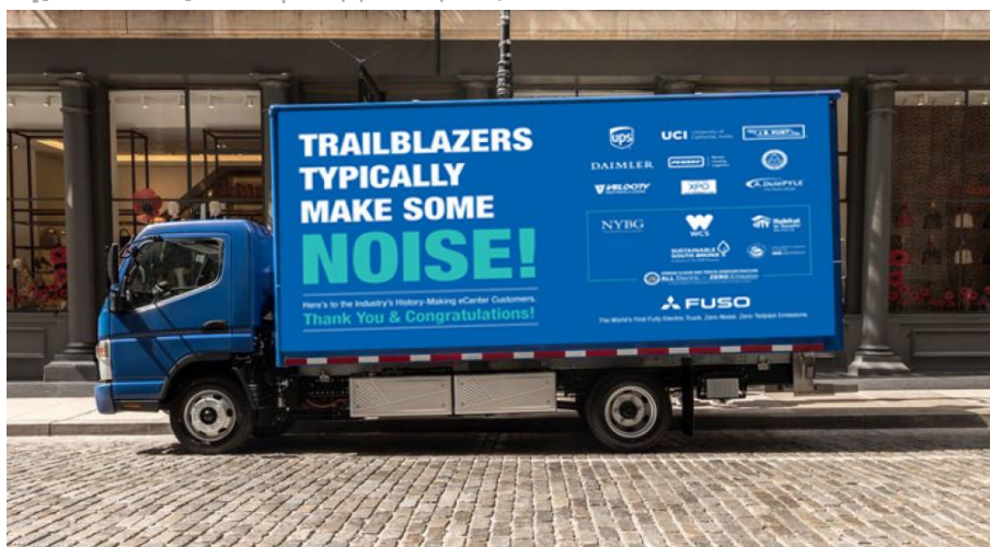
Εικόνα 4.4 Το Mitsubishi FUSO eCANTER με μπαταρία χωρητικότητας 82,5 kWh χρόνο φόρτισης 8 ώρες με AC και εύρος χωρίς επαναφόρτιση 130 χλμ.
